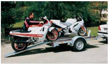
Müheloses Beladen durch extrem flachen Auffahrwinkel. Sicherer, beschädigungsfreier Transport durch verstellbare Radaufnahmen, vorne.
