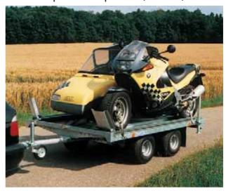
Der **Tandem-MH 752** ermöglicht den Transport von Fahrzeugen mit ungleichmäßiger Gewichtsverteilung. Zubehör: Sonderstandschienen für Gespann-Motorräder, Rohrstützen, Stützrad leicht.
