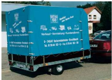
**MH 1350 in Fahrschulausrüstung.** Vorne abgeschrägter Planenaufbau für geringeren Luftwiderstand, extra lange Zugdeichsel, 1350 kg Gesamtgewicht.
