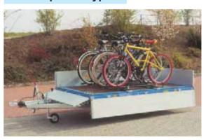
**ECO-Toplader mit Lastenträger** am seitlichen Zurrprofil festgeklemmt. Am Lastenträger können bis zu 9 Fahrradträger montiert werden. Die Lenker dürfen aber nicht überstehen, sondern müssen an den beiden äußeren Fahrrädern gedreht werden.
