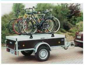
**HO 1001**, mit Thermodeckel, spritzwasserdicht, mit Gasdruckdämpfer als Hebehilfe. Auf dem Deckel kann ein Lastenträger und Fahrradaufsätze montiert werden.
