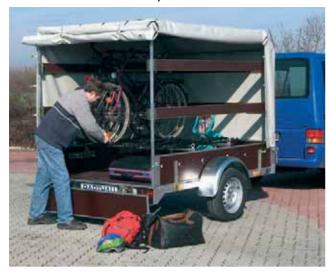
**MO** oder MH für Fahrradtransporte: Bei einer Kastenbreite von 1300 mm können auf den Lastenträger Fahrradständer für bis zu max. 5 Räder und bei einer Kastenbreite von 1600 mm für bis zu max. 7 Räder montiert werden. Beim Typ MH müssen die äußeren Lenker ev. gedreht werden, da seitlich nichts überstehen darf.
