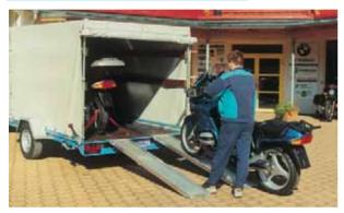
**U 1601 in Fahrschulausrüstung** mit Dachgestell und Plane, Ladehöhe 1650 mm. Mit Motorradtransportausrüstung können auch Fahrschulmotorräder bequem transportiert werden. Durch die Breite von 1860 mm können auch zwei große Motorräder verladen werden.
